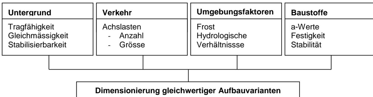
Eine zweite Möglichkeit ist in der VSS Norm 640'733b Oberbauverstärkung dargelegt. Die Verstärkungsdicke wird nach der massgebenden Deflektion (Einsenkung der Fahrbahnoberfläche mit definierter Radlast) und dem massgebenden Verkehr dimensioniert.
