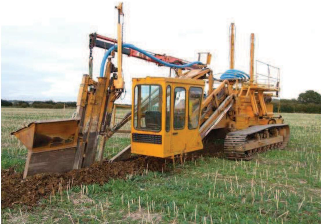
Abb. 13: Verlegemaschine zur voll mechanisierten Verlegung von Drainageröhren (Bildquelle: Dave Hitchborne / Wikipedia)
