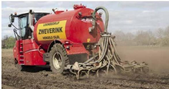
In den Niederlanden ist das direkte Einarbeiten der Gülle mit 6 oder 9 m breiten Geräten üblich. In diesem Fall ist die Querverteilung auch bei reduzierter Pumpendrehzahl kein Problem.
