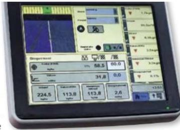
Das Terminal zeigt in der unteren Bildschirmzeile die aktuellen Mengen der ausgebrachten Nährstoffe in kg/ha an.
