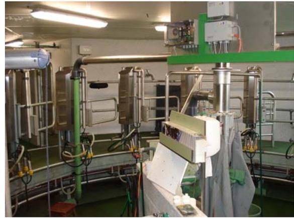
*Corridoio con mangiatoia e box a due file. L'impianto d'illuminazione fissato alle pareti e il rivestimento in lamiera forata della facciata sud della stalla assicurano la necessaria luminosità e il mantenimento di un clima consono. A destra: Impianto di mungitura a carosello (16 postazioni).*
