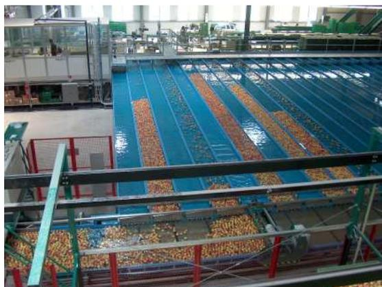
*Installation de triage de la production au moyen de canaux à eau*
